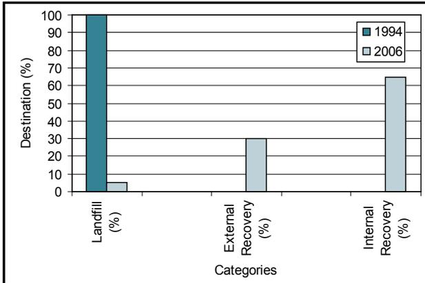
**Figure 88: HRM sludge utilisation**
