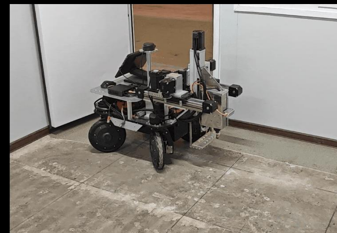
Intelligent Nailing Robot 智能打钉机器人
