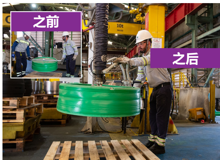
由两名操作人员手动搬运。 > 带吸力系统的吊装辅助运输。
