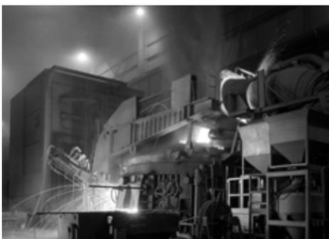
电弧炉炼钢工艺
